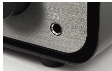
Dla wyjścia słuchawkowego przygotowano niezależny od końcówek mocy układ wzmacniający.
