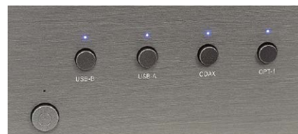
Oryginalnie, ale niezbyt czytelnie zaaranżowano wskaźnik poziomu głośności, w który „wcielają” się diody przygotowane dla poszczególnych wejść.
